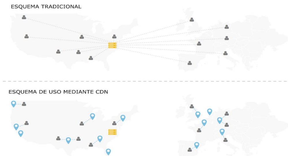
Figura 1.- Esquema de funcionamiento de una red CDN
