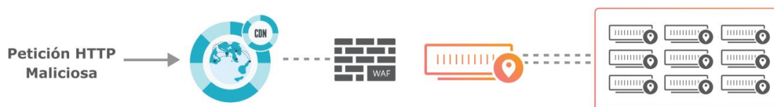
Figura 17.- Sistema de protección WAF basado en CDN
