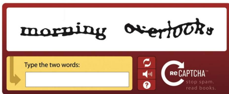
Figura 9.- Ejemplo de funcionamiento de un sistema desafío-respuesta basado en CAPTCHA
