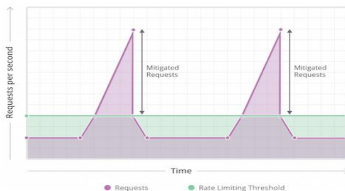
Figura 15.- Funcionamiento de Rate Limiting
